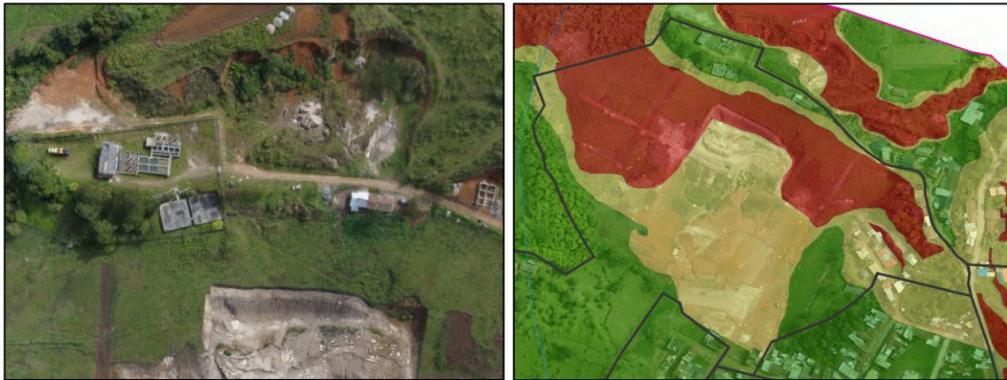
Ilustración 318 Vista local de la categorización de Amenaza por movimiento en masa en el Barrio Konrad Preuss Fuente: Geocing SAS.
