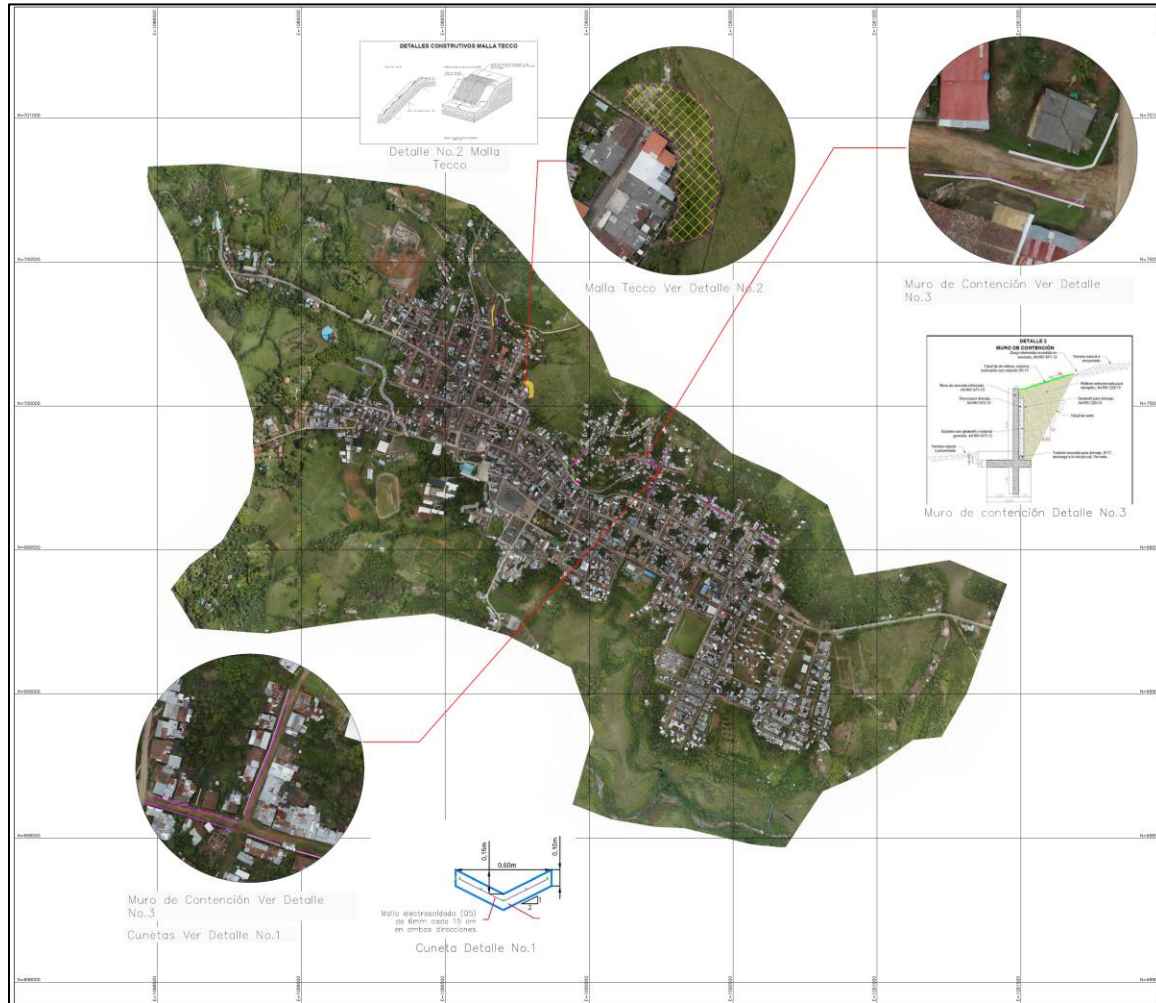
Ilustración 288 Vista en planta de la localización de las medidas estructurales recomendadas en el barrio Siloé parte 2. Fuente Geocing SAS.
