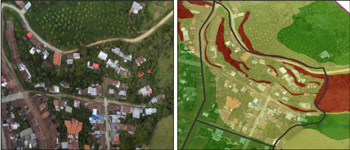
Ilustración 159 Vista local de la categorización de Amenaza por movimiento en masa en el Barrio Los Olivos. Fuente: Geocing SAS.
