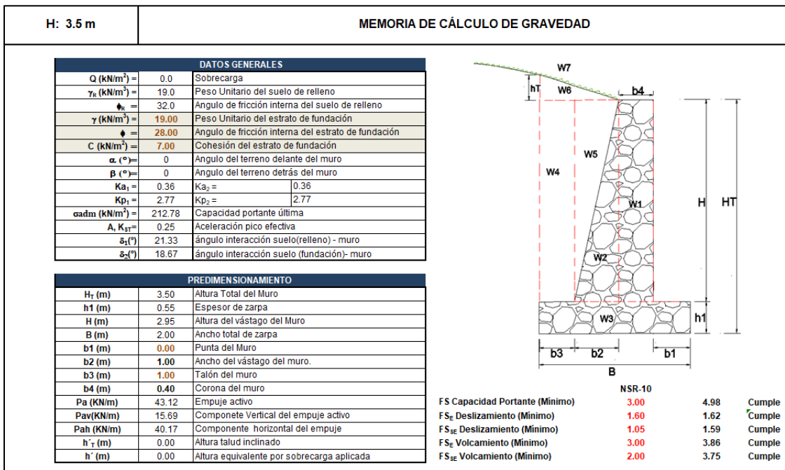
Ilustración 293 Dimensionamiento del Muro de gravedad H: 3.5 m.
