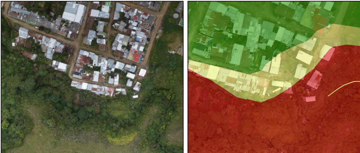
Ilustración 162 Vista local de la categorización de Amenaza por movimiento en masa en el Barrio Nueva Alianza. Fuente: Geocing SAS.
