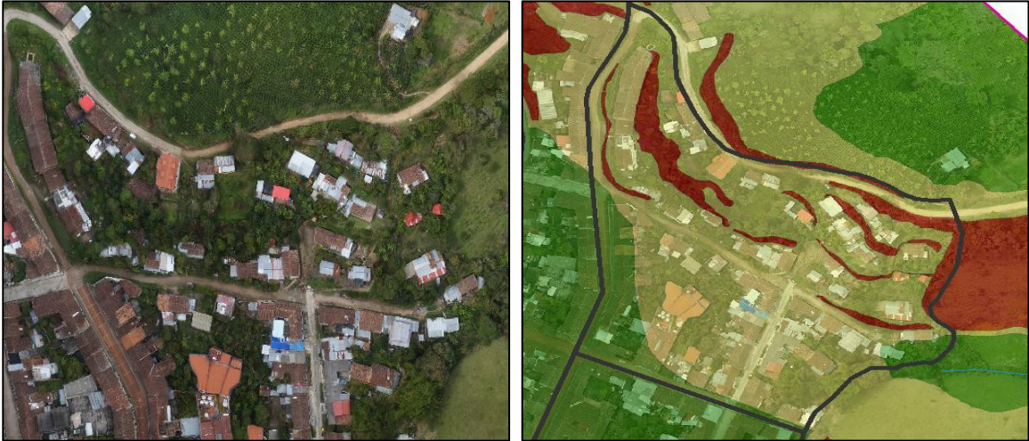
Ilustración 302 Vista local de la categorización de Amenaza por movimiento en masa en el Barrio Los Olivos. Fuente: Geocing SAS.
