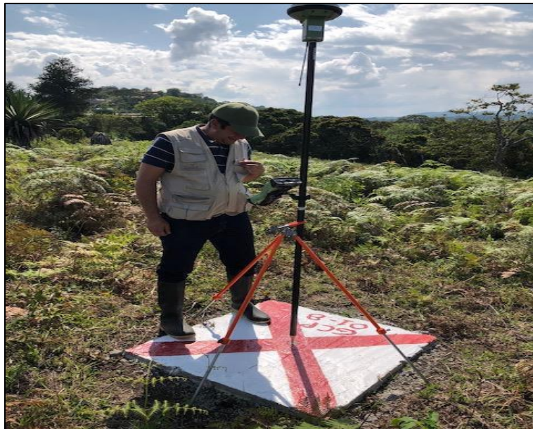
Ilustración 22. Procedimiento en campo toma de GCP. Fuente: Geocing SAS
