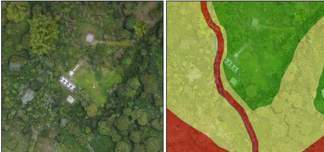
Ilustración 319 Vista local de la categorización de Amenaza por movimiento en masa en el predio de Planta de Tratamiento de Aguas Residuales. Fuente: Geocing SAS.
