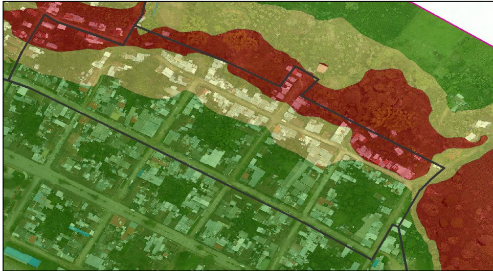
Ilustración 289 Vista local de la categorización de Amenaza por movimiento en masa en el Barrio La Brisas. Fuente Geocing SAS.
