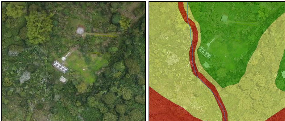
Ilustración 161 Vista local de la categorización de Amenaza por movimiento en masa en el predio de Planta de Tratamiento de Aguas Residuales. Fuente: Geocing SAS.
