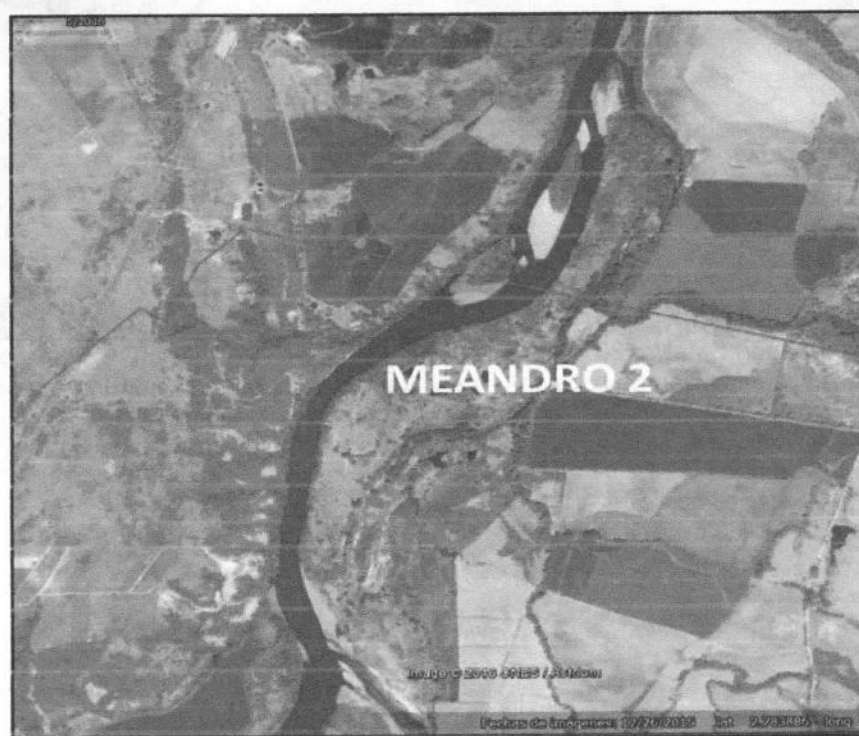
Figura. Imagen Satelital 2015, se evidencia a hidrodinámica del meandro en estado de sedimentación y/o abandono
