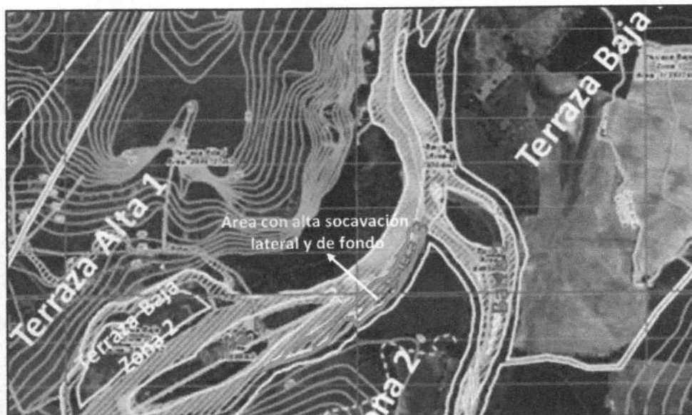
Figura. Imagen satelital en la cual se evidencian los fuertes procesos erosivos o de socavación en el sector de la barra 3 (explotación de materiales de construcción "arrastre") aguas arriba desembocadura del río Neiva al Magdalena
