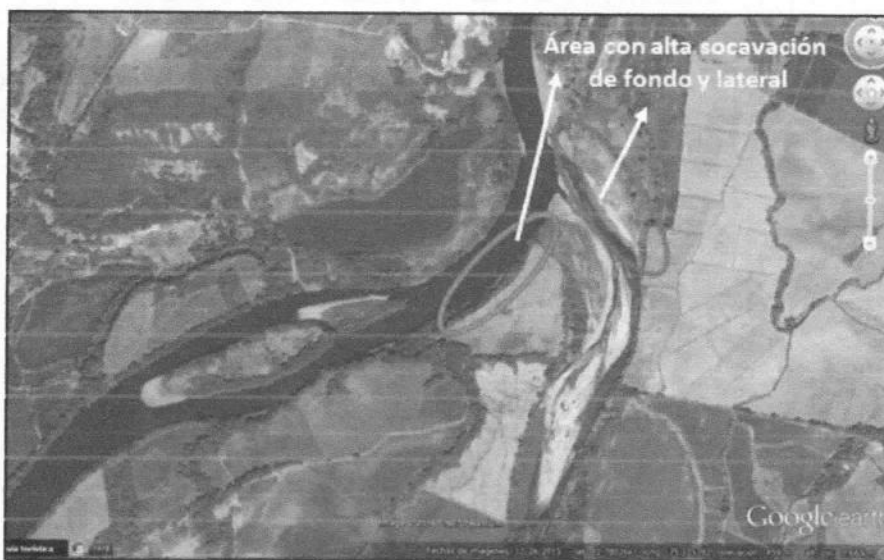
Figura. Imagen satelital 2015, en la cual se evidencian los fuertes procesos erosivos o de socavación en el sector de las barras 2 y 3 (explotación de materiales de construcción "arrastre")
