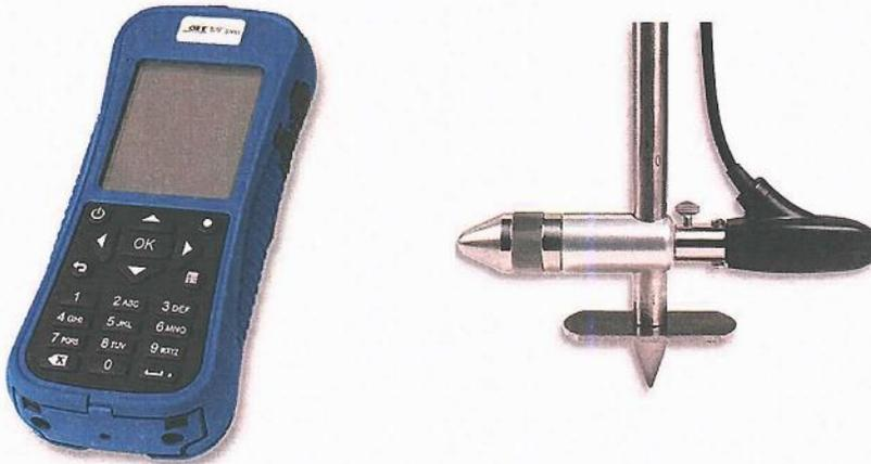
*Imagen 6: Equipo utilizado para la medición de caudal*
