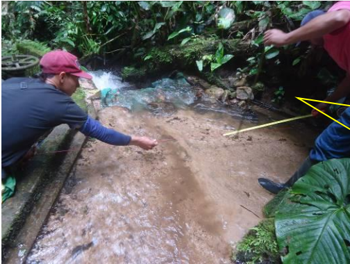
Aforo sobre la bocatoma
