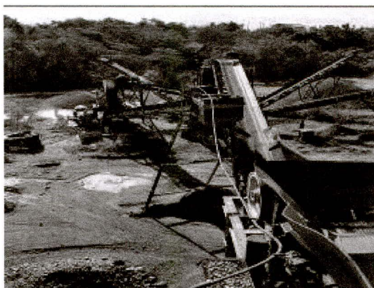
Foto 5-6-7-8-9-10. Identificación de la tolva alimentadora, trituradora primaria, impactor y bandas transportadoras.
