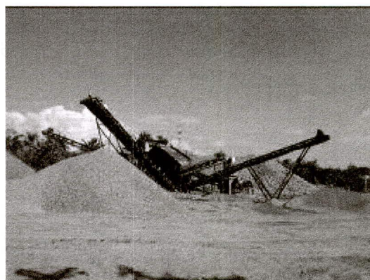
Foto 5-6-7-8-9-10. Identificación de la tolva alimentadora, trituradora primaria, impactor y bandas transportadoras.
