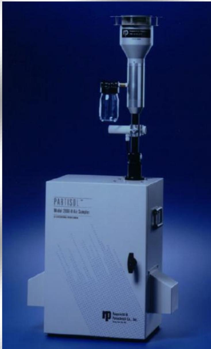
Figura 16. Equipo de muestreo de bajo volumen para PM2.5.
