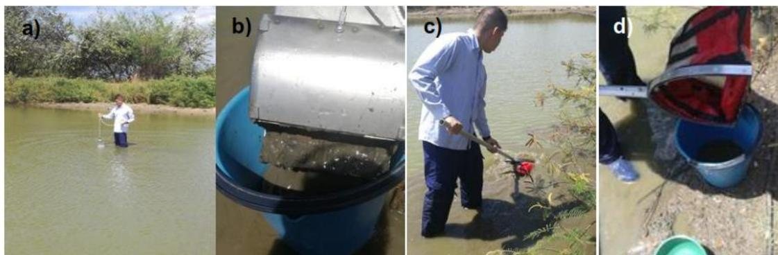
**Figura 92. Toma de muestras de macroinvertebrados acuáticos en el humedal El Curíbano. a) y b) Draga Eckman, c) y d) red tipo D.**
