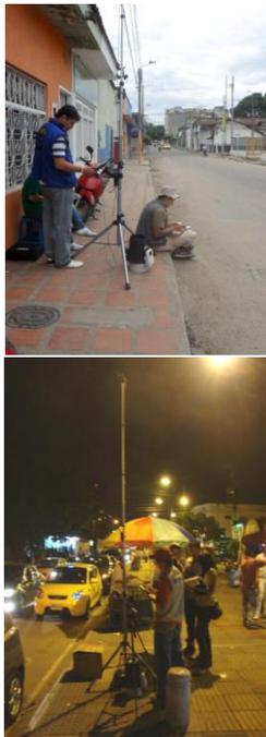
Medición de ruido ambiental a 4 metros de altura (Franjas Horarias Diurna y Nocturna).
