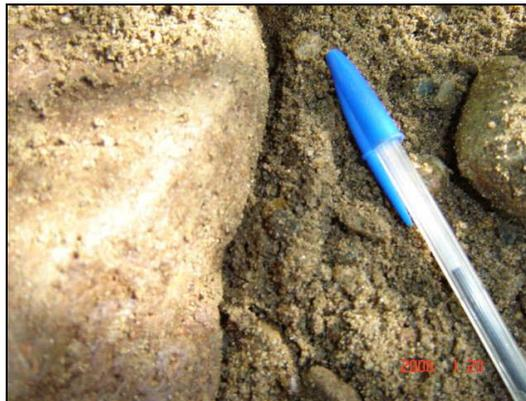
**Foto 7 - 2: Material de la excavación, Matriz areno limosa con guijarros de gran tamaño y trazas de grava. Profundidad aproximada 0,7 m.**
