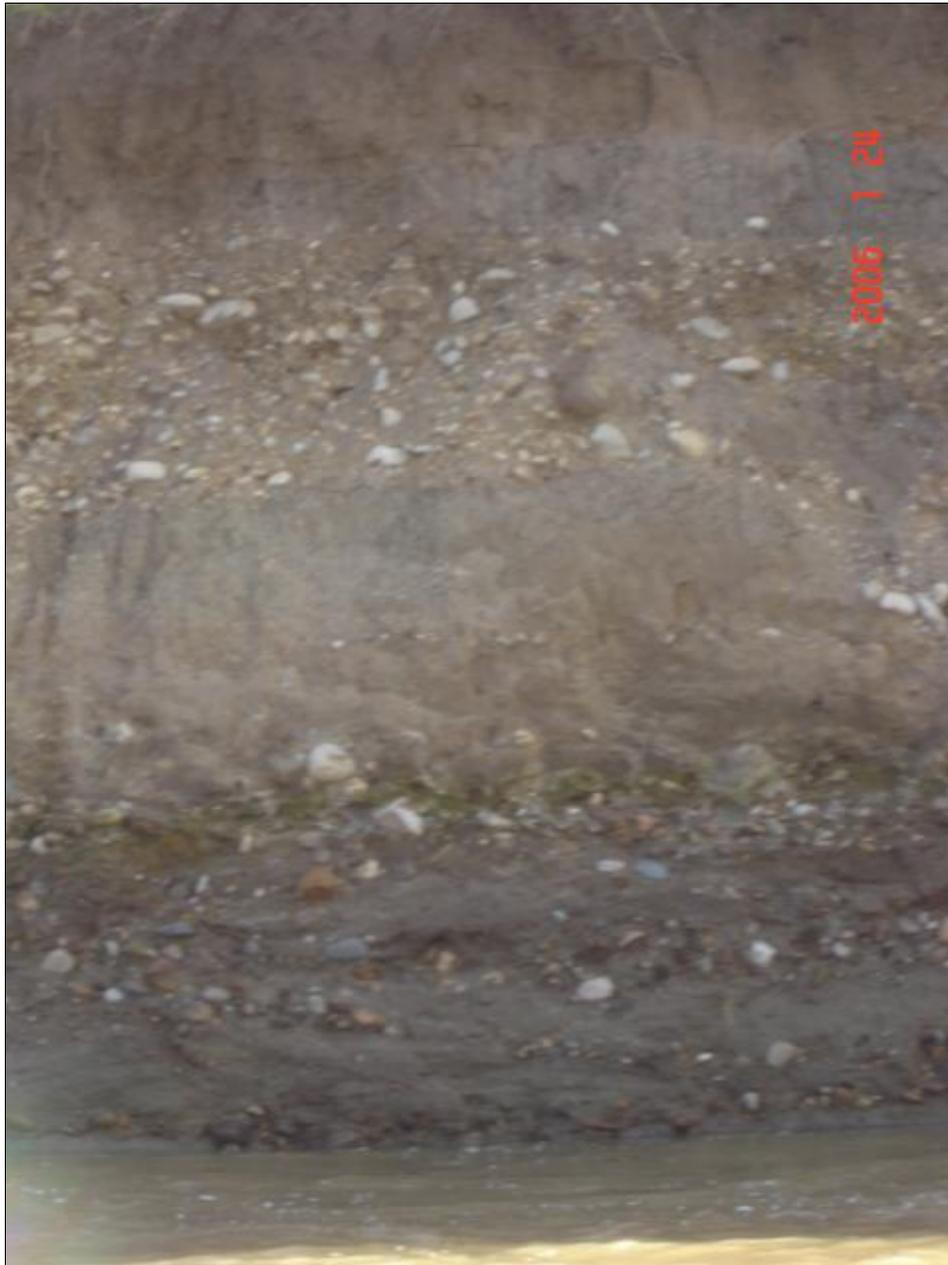
**Fotografía No 1.** En esta fotografía, se observa una capa de limo orgánico (0.7m), seguida de una capa de limo arenoso (2m) dentro de la cual se encuentran arenas gravas y clastos (1m) en matriz arenosa, hacia la base se observa nuevamente arenas gravas y clastos.
