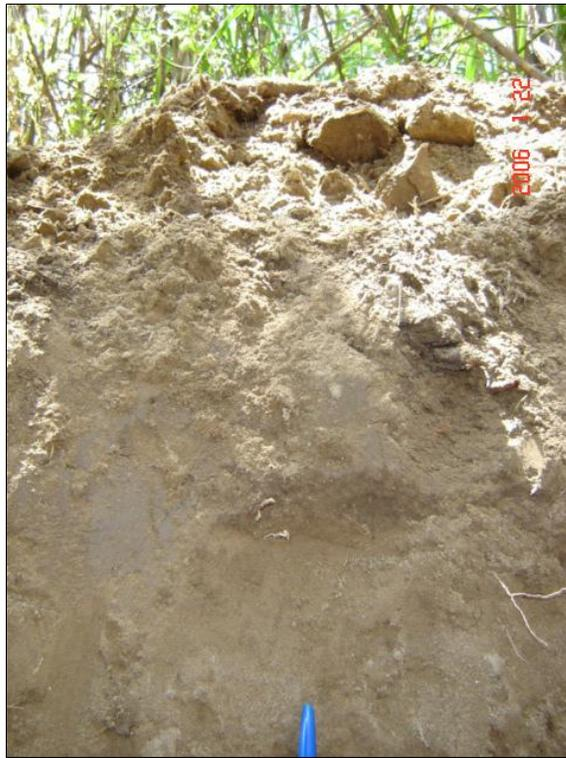
**Foto 19 - 4: Parte superior de la excavación. Matriz limo arenosa con capa vegetal. Profundidad aproximada 0,20 m.**
