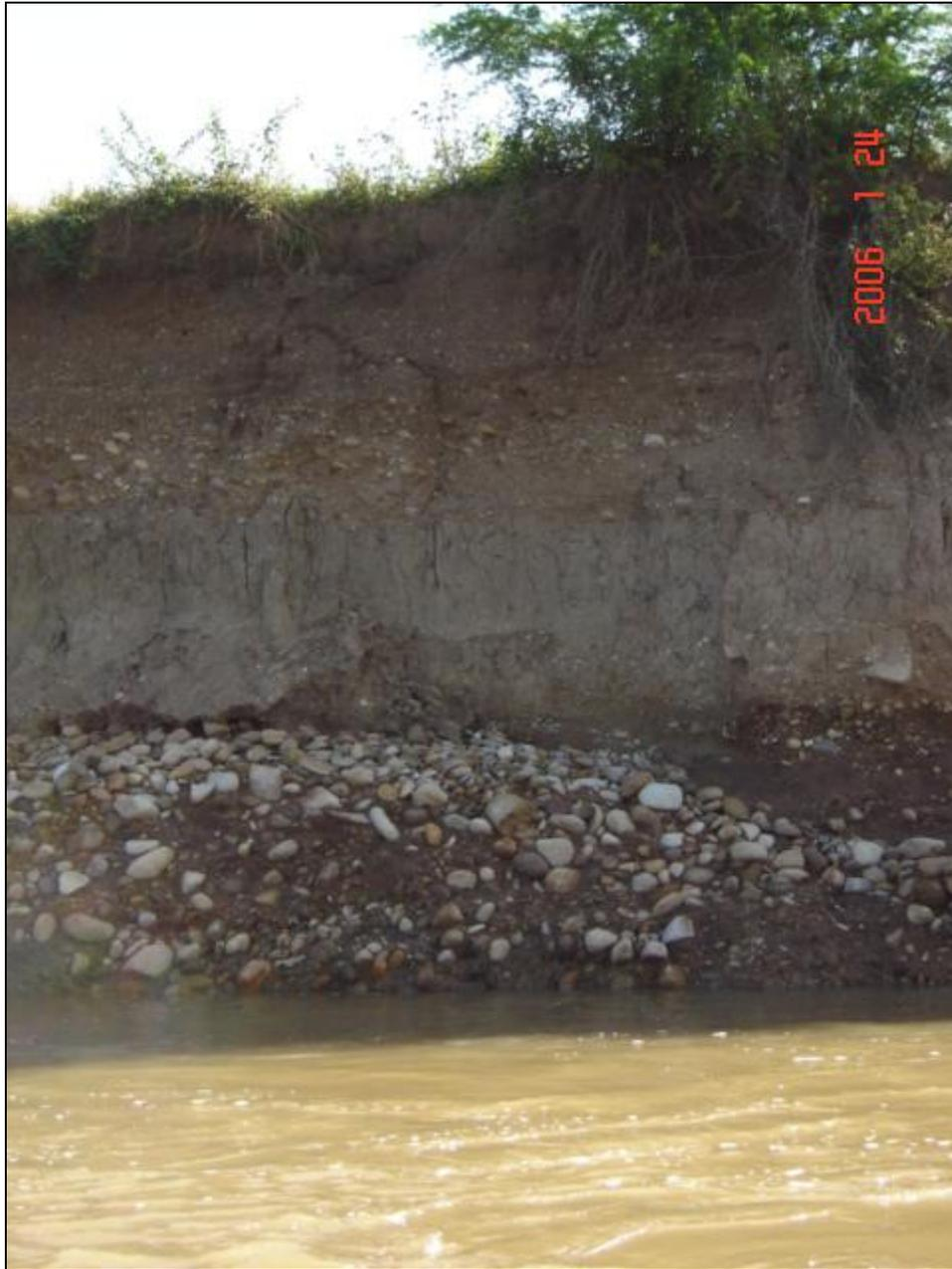
**Fotografía No 2.** En esta fotografía, se observa una capa de limo orgánico (0.7m), seguida de una capa de gravas finas en matriz limosa (1.5m). posteriormente, se encuentra nuevamente una capa de limo arenoso (1.5m) y en la base arenas, gravas y clastos.
