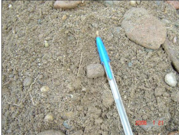
**Foto 21 - 2: Material de la excavación. Matriz de limo arenoso con algunas raíces y trazas de guijarros. Profundidad aproximada 0,40 m.**
