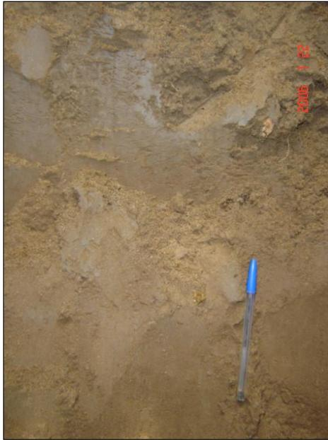
**Figura 20 - 4: Transición entre la matriz areno limosa y limo arenosa con raíces. Profundidad aproximada 0,50 m.**
