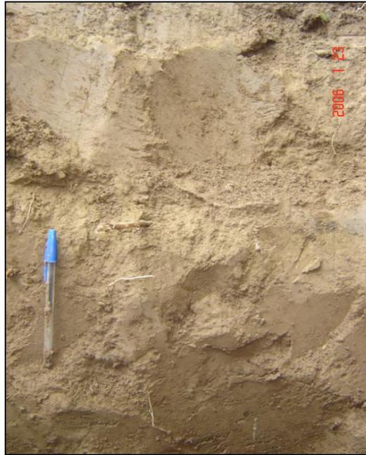
**Foto 35 - 6: Transición entre la matriz de limo arcilloso y la de limo con presencia de raíces. Profundidad aproximada 0, 30 m.**
