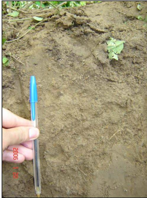
**Foto 7 - 5: Parte superior de la excavación, matriz areno limosa, en transición con la limosa, seguida de la capa vegetal. Profundidad aproximada 0,40.**
