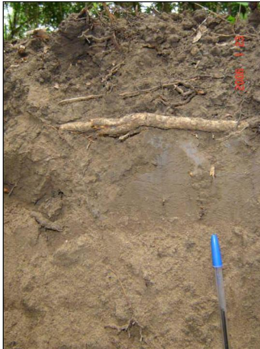
**Foto 34 - 4: Transición entre la matriz de arena limosa y la de limo con presencia de raíces. Profundidad aproximada 0,30 m.**
