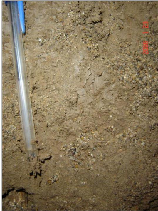
**Foto 35 - 4: Transición entre la matriz de arena y la de limo arcilloso. Profundidad aproximada 1,50 m.**
