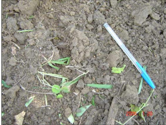
**Foto 9 - 1: Material de la excavación, Limo con presencia de raíces en estado seco. Profundidad aproximada 0,1 m.**
