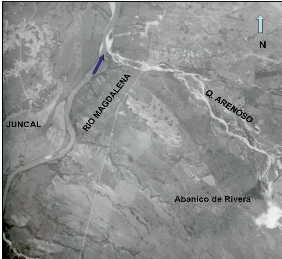
*Donde se aprecia el tramo 1, desde el Juncal hasta La Quebrada Arenoso. Nótese el alto aporte de sedimentos de esta fuente que ha influido en la dinámica del sector insular aguas abajo en el tramo 2. Para este tramo el cauce es unicanal recto con algunas barras en las partes sinuosas del cauce.*
