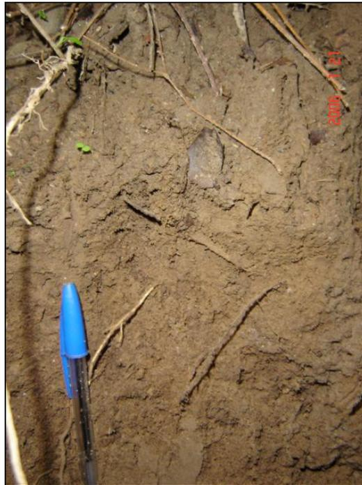
**Foto 37 - 3: Transición entre la matriz areno limosa y limo arenosa con presencia de raíces. Profundidad aproximada 0,20 m.**
