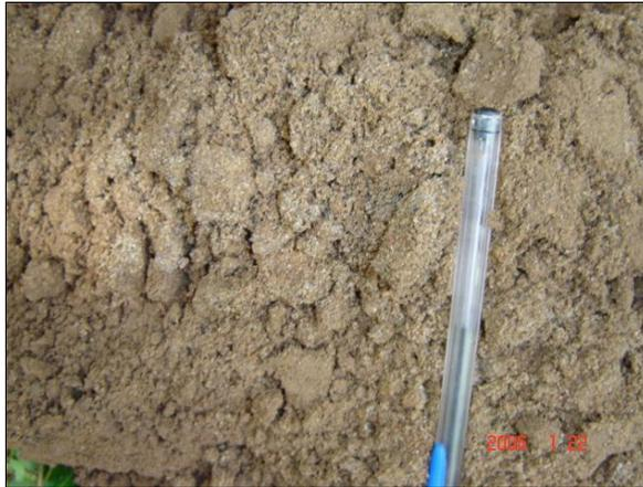
**Figura 20 - 2: Material de la excavación. Matriz de arena limosa. Profundidad aproximada 1,00 m.**
