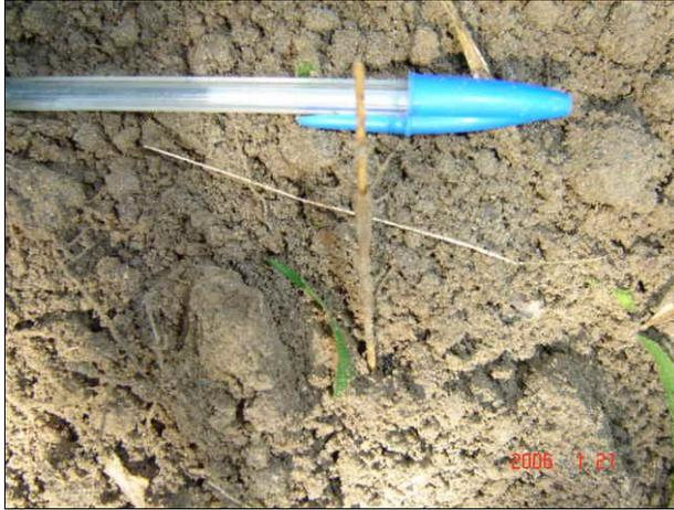
**Foto 21 - 1: Material de la excavación, limo arenoso con raíces. Profundidad aproximada 0,1 m.**
