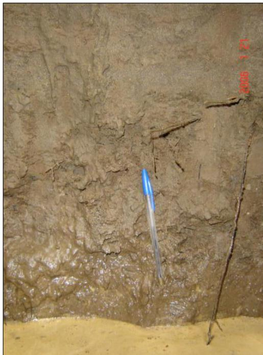
**Foto 27 - 2: Fondo de la excavación. Presencia del nivel freático. Transición entre la matriz de limo arenoso saturado y la de limo arenoso con presencia de raíces en estado seco. Profundidad aproximada 1,20 m.**
