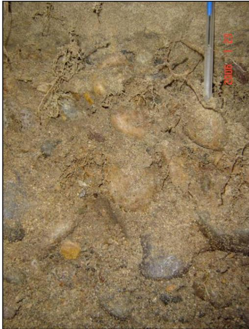
**Foto 33 - 4: Transición entre la matriz arenosa con guijarros y la arena limosa con presencia de raíces. Profundidad aproximada 0,50 m.**
