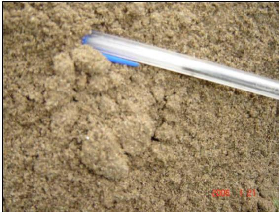
**Foto 14 - 2: Material de excavación. Matriz de arena limosa con algunas raíces. Profundidad aproximada 0,50 m.**
