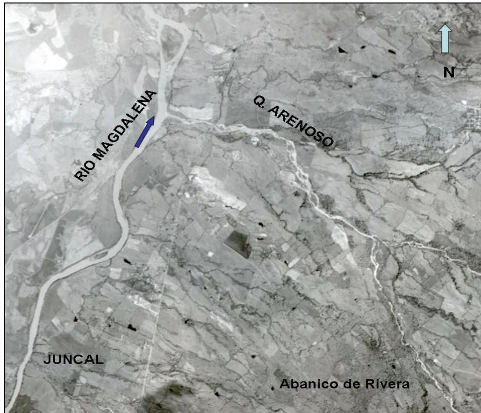
Donde se aprecia el tramo 1, desde el Juncal hasta La Quebrada Arenoso. Nótese el incremento en el tamaño de las barras con respecto a la imagen anterior, las cuales están estabilizadas, tanto en el cauce como en las orillas. Los sedimentos de la Q. Arenoso han sido distribuidos aguas abajo, hacia el sector insular aguas abajo en el tramo 2. Para este tramo el cauce es unicanal recto sin cambios y con escasas barras en las partes sinuosas del cauce.
