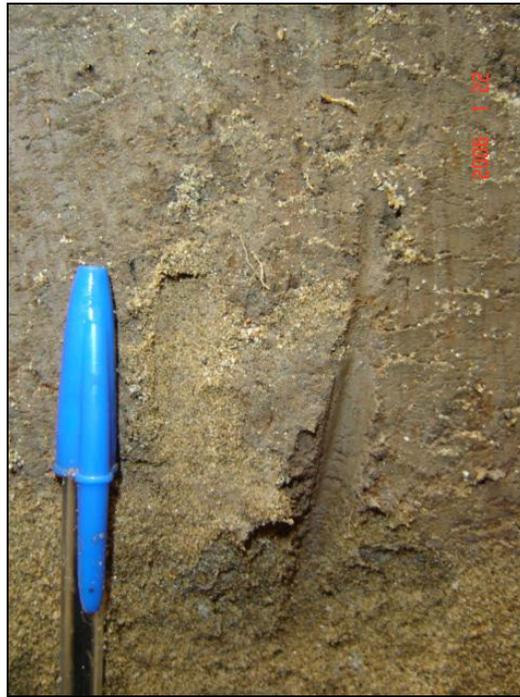
**Foto 17 - 6: Detalle de la transición entre la matriz areno limosa y limo arenosa. Profundidad aproximada 0,50 m.**
