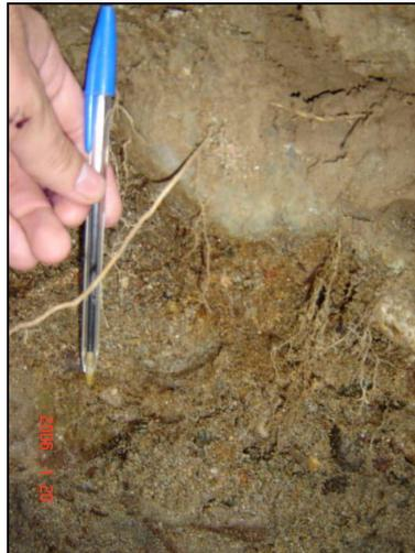
**Foto 7 - 4: Transición de la matriz limosa con presencia de raíces a arenosa con guijarros. Profundidad aproximada 0,60 m.**
