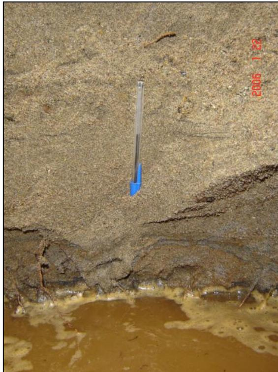
**Foto 17 - 3: Fondo de la excavación. Presencia del nivel freático. Transición entre la matriz de arenosa saturada y húmeda. Profundidad aproximada 1,00 m.**
