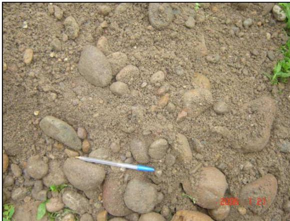
**Foto 14 - 3: Material de excavación. Matriz arena limosa con guijarros y gravas. Profundidad aproximada 0,50 m**
