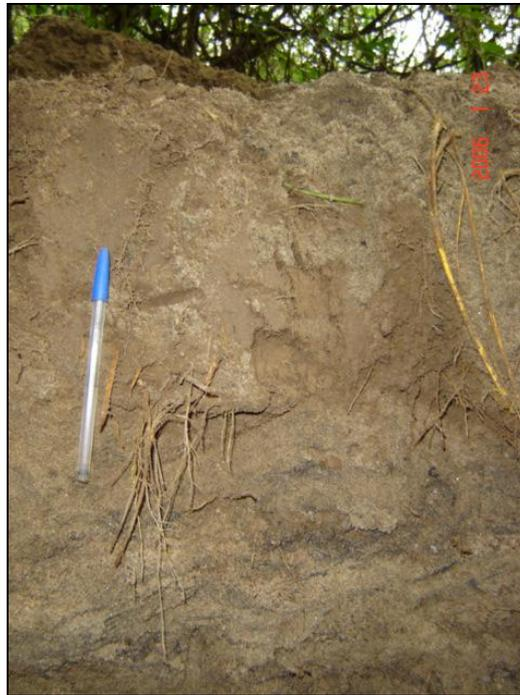
**Foto 33 - 5: Transición entre la matriz areno limosa y la limo arenosa con presencia de raíces. En la parte superior la matriz limosa y la capa vegetal. Profundidad aproximada 0,60 m.**
