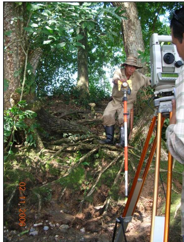
**Fotografía 8: Levantamiento topográfico de secciones. Se observa rápido incremento de niveles**
