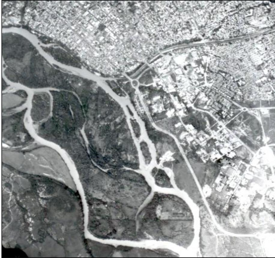
*Se aprecia el sistema de barras e islas frente a la Ciudad de Neiva. Nótese en color más oscuro las zonas de bosque y vegetación que en las orillas controlan la socavación, así como los canales de inundación por donde se desborda el río en zonas de paleocanales o descargas. Los paleocanales se notan como líneas tenues dentro de las islas.*
