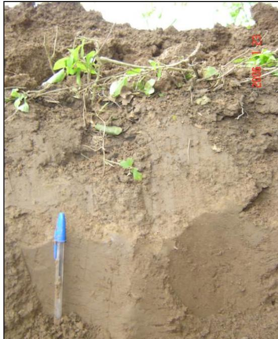
**Foto 35 - 7: Parte superior de la excavación. Se observa la transición entre la capa de limo arcilloso y la de limo con presencia de capa vegetal en la parte superior. Profundidad aproximada 0, 20m.**
