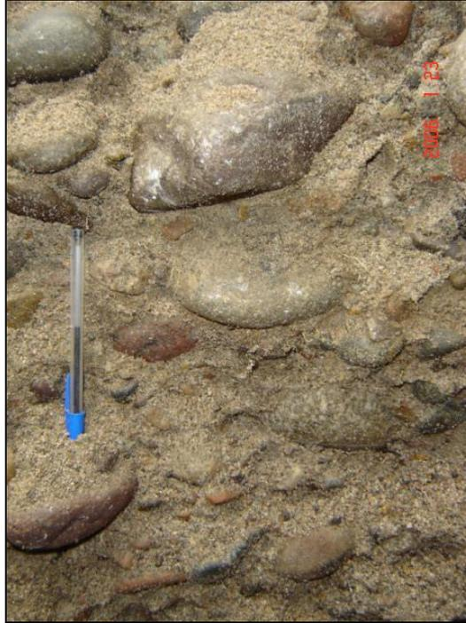
**Foto 29 - 4: Parte final de la excavación. Matriz arenosa con guijarros de gran tamaño embebidos. Profundidad aproximada 1,80 m.**
