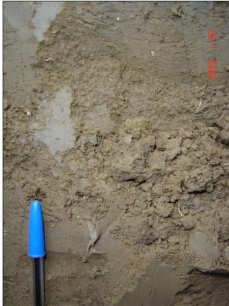
**Foto 8 - 4: Matriz limo arcillosa, con trazas de raíces. Profundidad aproximada 0,40.**
