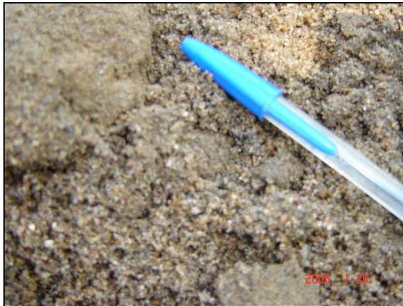
**Foto 9 - 2: Material de la excavación, Matriz arenosa con limo. Profundidad aproximada 1,20 m.**
