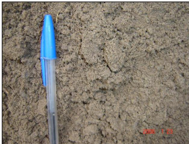
**Foto 34 - 1: Material de la excavación. Limo con presencia de raíces. Profundidad aproximada 0,15 m.**
