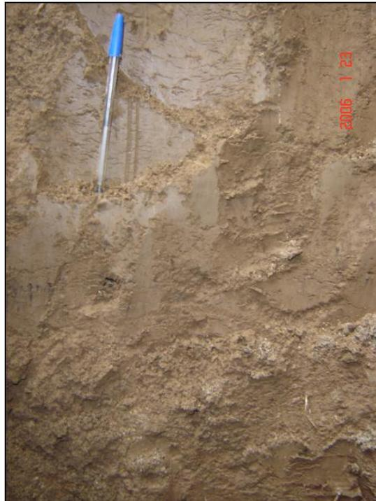
**Foto 35 - 5: Matriz de limo arcilloso con presencia ocasional de raíces. Profundidad aproximada 1,00 m.**
