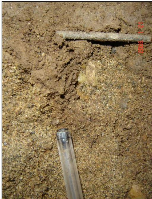
**Foto 37 - 2: Transición entre matriz arenosa y arenolimsa. Profundidad aproximada 0,50 m.**
