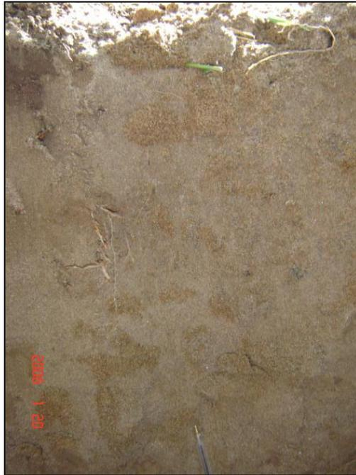
**Foto 15 - 4: Parte superior de la excavación de arena fina limosa con raíces. Arriba la capa vegetal. Profundidad aproximada 0,30 m.**
