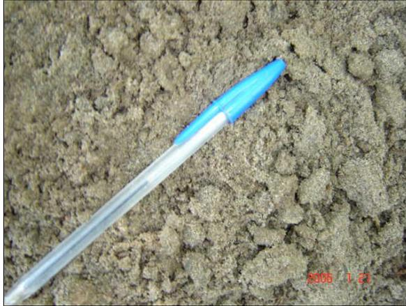
**Foto 22 - 1: Material de la excavación. Matriz de arena limosa. Profundidad aproximada 0,20 m.**
