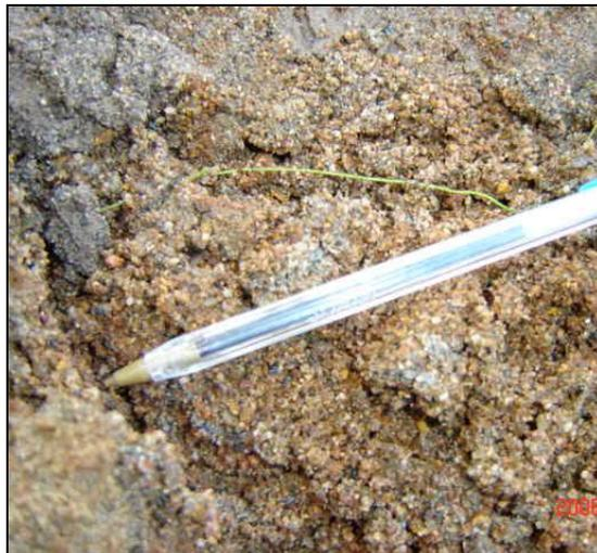
**Foto 9 - 3: Material de la excavación, Matriz arenosa con limo. Profundidad aproximada 1,50 m.**
