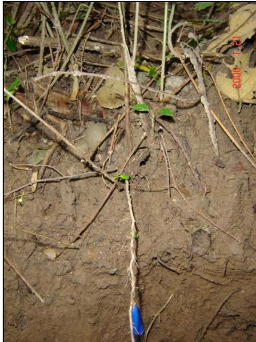
**Foto 37 - 4: Parte superior de la excavación. Matriz limo arenosa con presencia de raíces y capa vegetal. Profundidad aproximada 0,15 m.**
