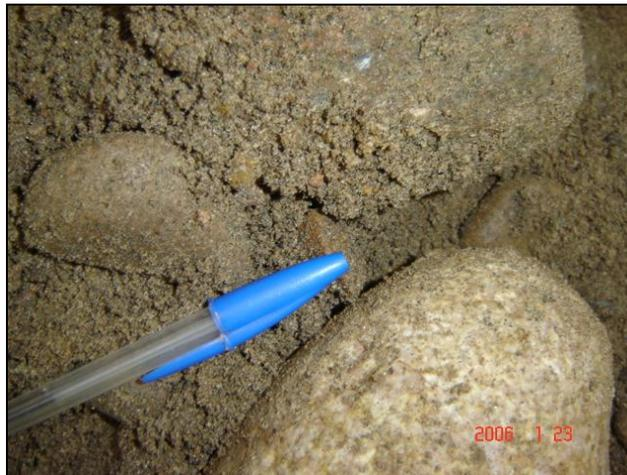
**Foto 33 - 2: Material de la excavación. Matriz de arena con gujarros de gran tamaño. Profundidad aproximada 0,80 m.**
