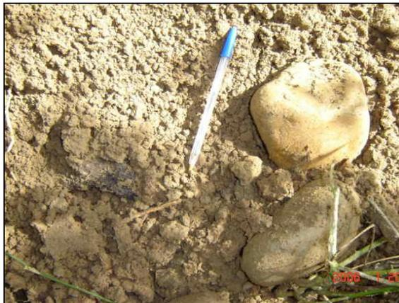
**Foto 7 - 1: Material de la excavación, matriz limo arenosa con guijarros. Profundidad aproximada 0,3 m.**
