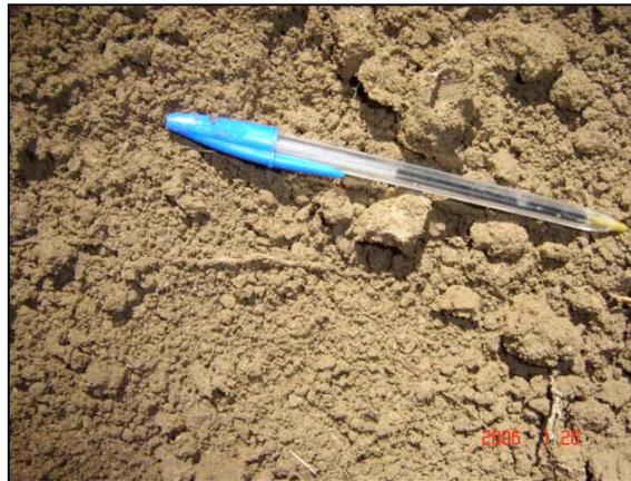
**Foto 8 - 1: Material de la excavación, Matriz limosa arcillosa con trazas de raíces. Profundidad aproximada 0,3 m.**
