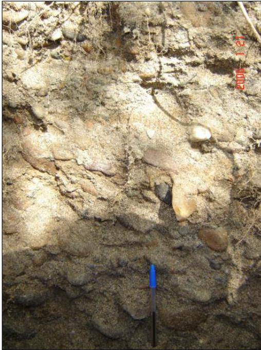
**Foto 21 - 5: Transición entre la matriz arenosa y limo arenosa con guijarros. Profundidad aproximada 0,70 m.**
