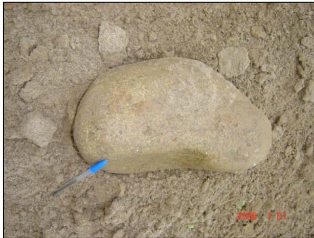
**Foto 14 - 4: Material de excavación. Tamaño máximo de fragmentos subredondeados. Profundidad aproximada 0,70 m.**
