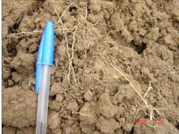
**Foto 29 - 1: Material de la excavación. Limo con presencia de raíces. Profundidad aproximada 0,30 m.**
