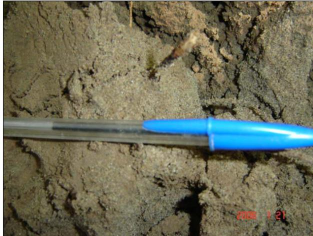
**Foto 27 - 1: Material de la excavación. Matriz de arena limosa. Profundidad aproximada 1,00 m.**
