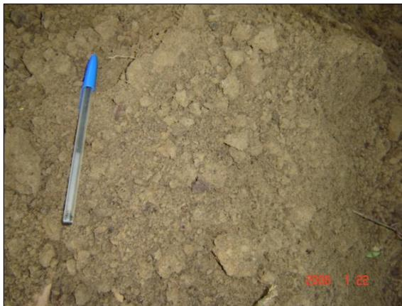
**Figura 20 - 1: Material de la excavación. Limo arenoso con presencia de raíces. Profundidad aproximada 0,20 m.**
