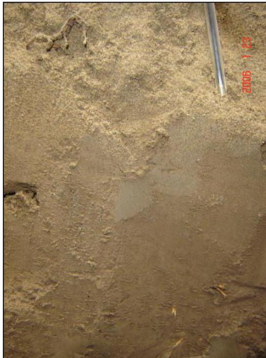
**Foto 34 - 3: Transición entre la matriz de limo arenoso y arena limosa con raíces. Profundidad aproximada 0,60 m.**
