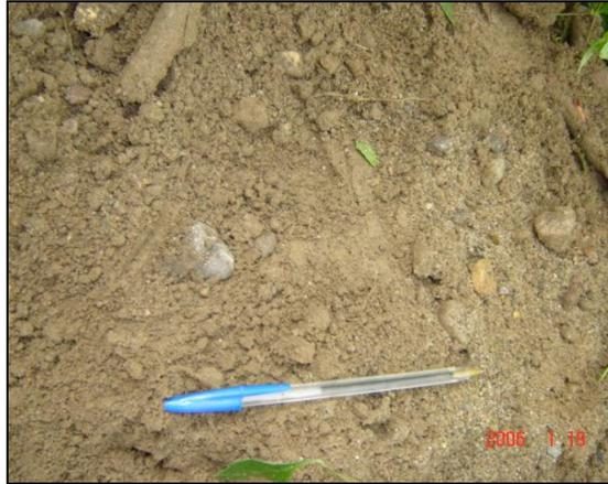
**Foto 4 - 1: Material de la excavación, matriz arenosa fina con grava gruesa subredondeada y trazas de limo. Profundidad aproximada 0,8 m.**
