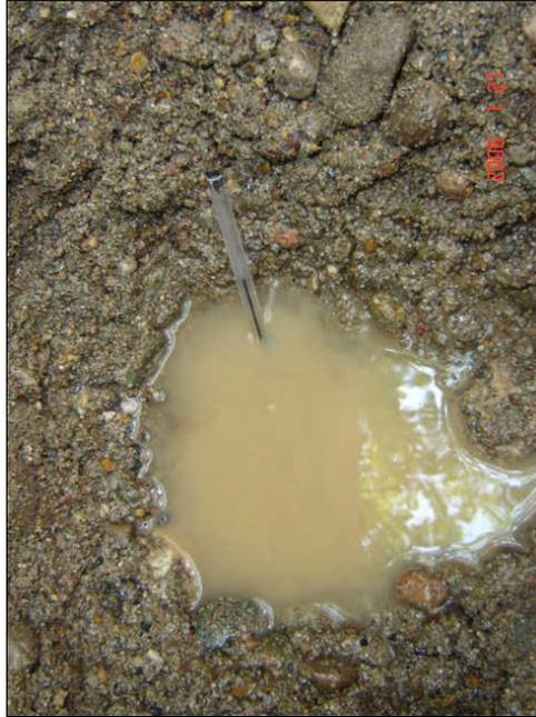
**Foto 22 - 4: Detalle del fondo de la excavación. Matriz arenosa con presencia de gravas y guijarros.**
