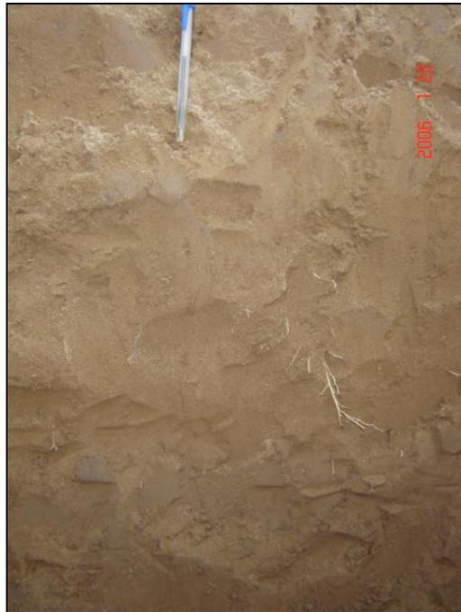
**Foto 19 - 3: Transición entre la matriz areno limosa y limo arenosa con raíces. Profundidad aproximada 0,30 m.**
