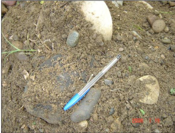
**Foto 3 - 1: Material de excavación, matriz areno limosa con gravas y guijarros. Obsérvese el tamaño de los guijarros. Profundidad aproximada 0,5 m.**
