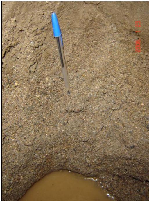
**Foto 35 - 3: Fondo de la excavación. Presencia del nivel freático. Matriz arenosa con guijarros. Profundidad aproximada 1,90 m.**
