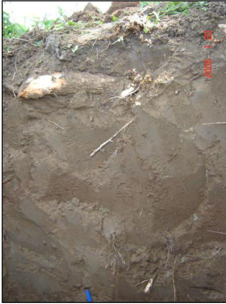
**Foto 9 - 6: Parte superior de la excavación, transición matriz limo arenosa con raíces, y la limosa. Aparece la capa vegetal. Profundidad aproximada 0,50 m**
