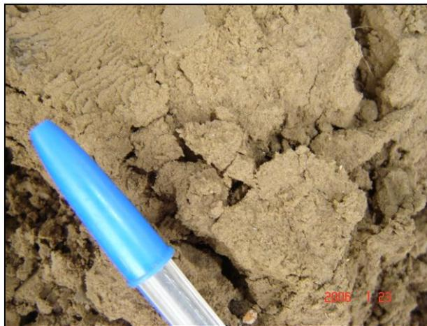
**Foto 35 - 1: Material de la excavación. Limo arcilloso con presencia de raíces. Profundidad aproximada 1,00 m.**
