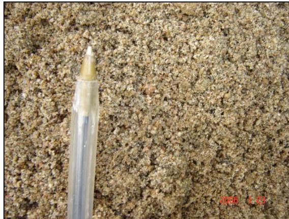
**Foto 29 - 2: Material de la excavación. Matriz de arena limosa. Profundidad aproximada 0,60 m.**
