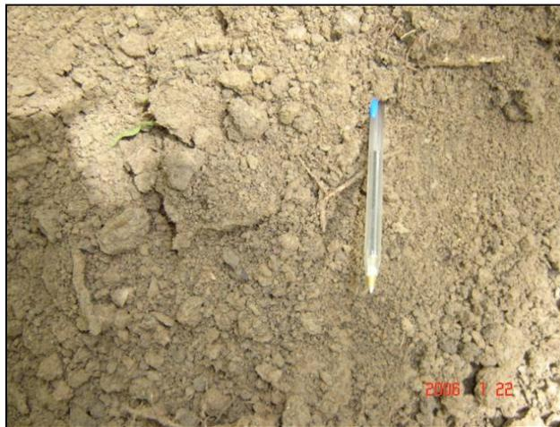
**Foto 17 - 1: Material de la excavación. Limo arenoso con arenoso con presencia de raíces. Profundidad aproximada 0,40 m.**
