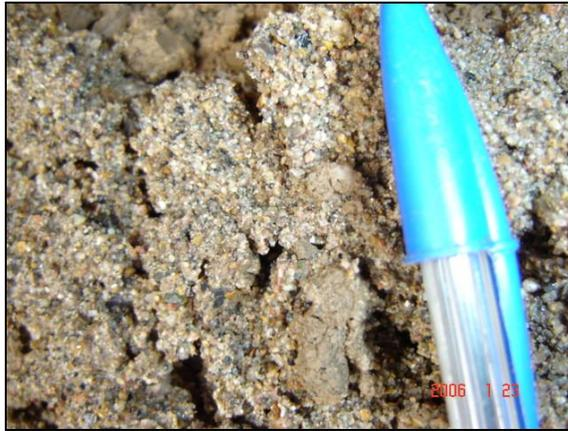
**Foto 35 - 2: Material de la excavación. Matriz arenosa. Profundidad aproximada 1,80 m.**
