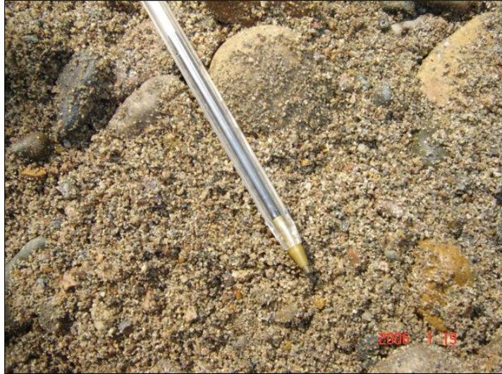
**Foto 1.1: Material de la excavación, matriz arenosa fina y trazas de grava fina y guijarros. Profundidad aproximada 0,5 m.**
