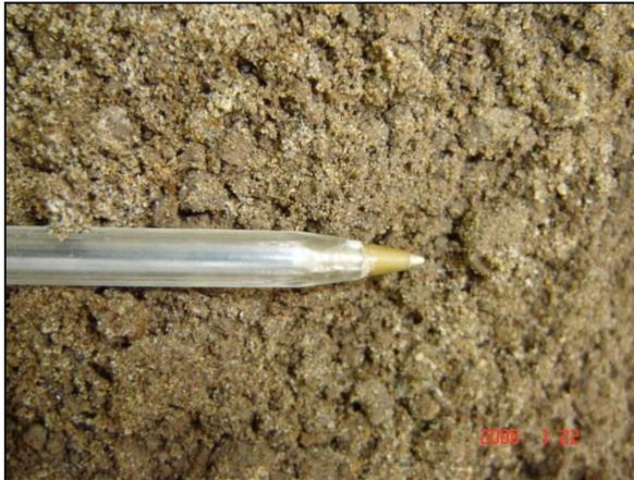
**Foto 17 - 2: Material de la excavación, arena fina limosa. Profundidad aproximada 0,70 m.**
