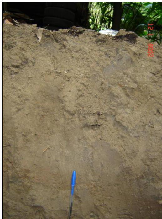
**Foto 27 - 4: Parte superior de la excavación matriz limo arenosa en la parte superior con una delgada franja en la parte inferior de la foto de limo arcilloso. Nótese la ausencia de capa vegetal. Profundidad aproximada 0,50 m.**
