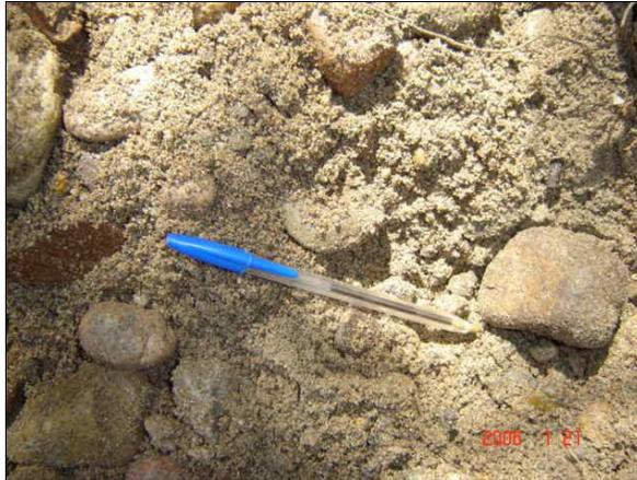
**Foto 22 - 2: Material de la excavación. Matriz arenosa con gravas y guijarros. Profundidad aproximada 0,80 m.**
