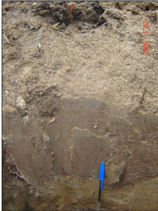
**Foto 17 - 8: Transición entre las matrices areno limosa, limo arenosa y limosa. Profundidad aproximada 0,50 m.**
