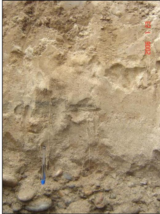
**Foto 29 - 6: Transición entre la matriz arenosa con guijarros, la arena limosa, y la limo arenosa con presencia de raíces. Profundidad aproximada 0**
