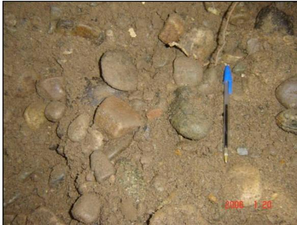
**Foto 8 - 2: Material de la excavación, Matriz arenosa con guijarros y grava gruesa. Profundidad aproximada 0,9 m.**
