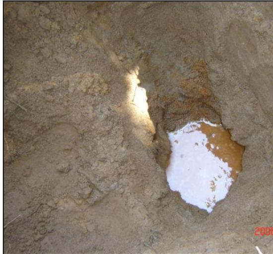
**Foto 9 - 4: Fondo de la excavación. Presencia del nivel freático en el apique 09. Arena fina color rojizo. Profundidad 1,40 m.**
