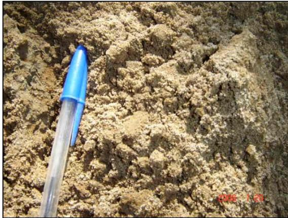
**Foto 15 - 2: Material de excavación. Matriz de arena limosa con algunas raíces. Profundidad aproximada 0,50 m.**
