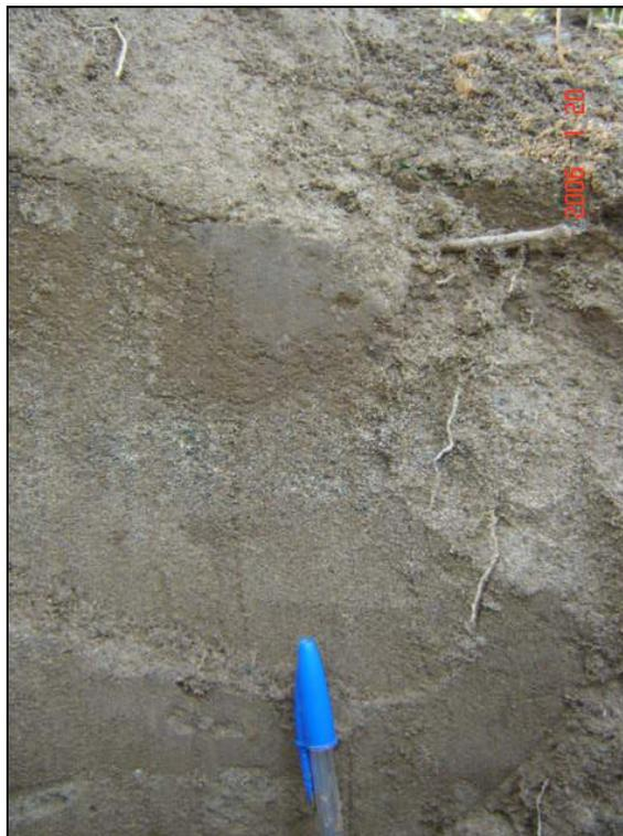
**Foto 10 - 5: Parte superior de la excavación. Matriz limo arenosa con presencia de raíces. Se observa la capa vegetal en la parte superior.**
