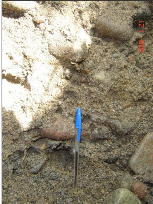
**Foto 21 - 3: Presencia al final de la excavación de una matriz arenosa con gujarros. Profundidad aproximada 1,10 m.**
