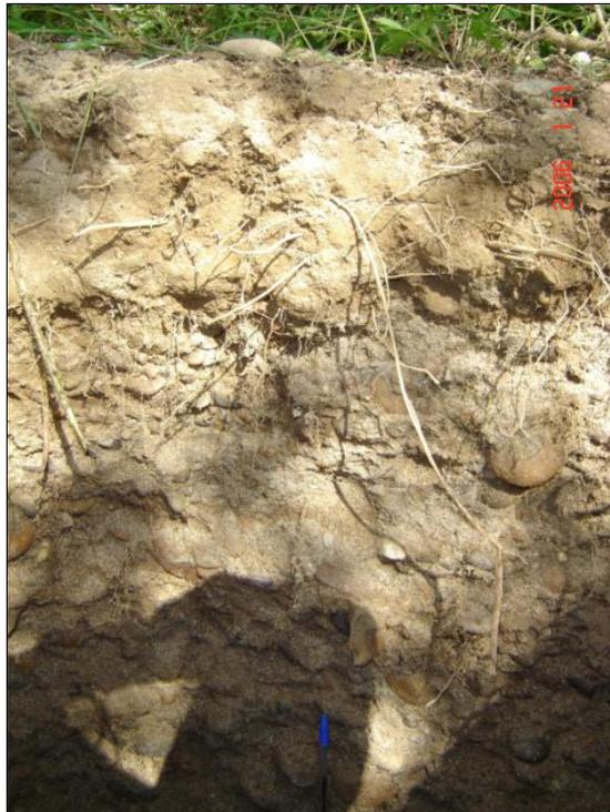
**Foto 21 - 6: Parte superior de la excavación. Se aprecia la transición entre la matriz limo arenosa con guijarros y la matriz limo arenosa con presencia de raíces. Profundidad**
