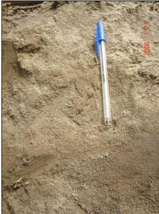
**Foto 14 - 8: Transición entre la matriz arenosa limosa y la limo arenosa. Se observa la capa vegetal en la parte superior. Profundidad aproximada 0,1**
