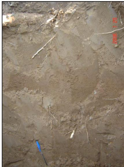
**Foto 9 - 5: Transición de la matriz areno limosa, y la limo arenosa con raíces. Profundidad aproximada 0,80.**
