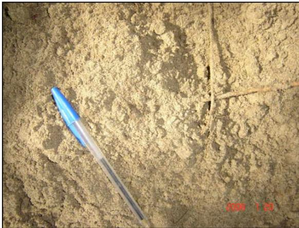
**Foto 15 - 1: Material de la excavación, Matriz de arena limosa con raíces. Profundidad aproximada 0,2 m.**
