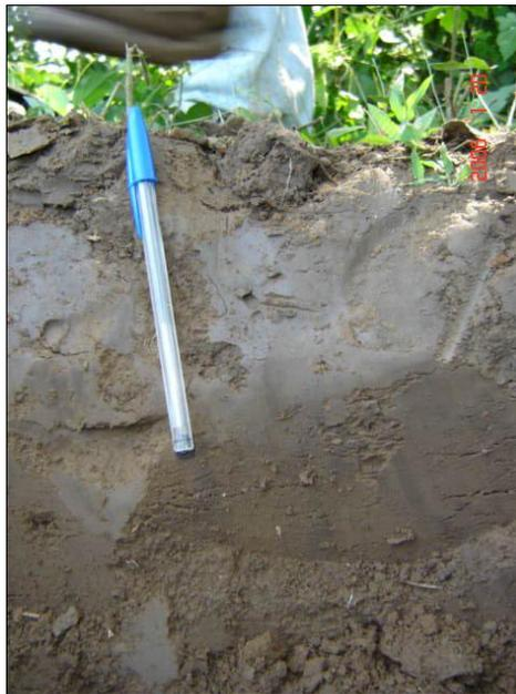
**Foto 8 - 5: Parte superior de la excavación, matriz de limo arcilloso, y capa vegetal. Profundidad aproximada 0,20 m**
