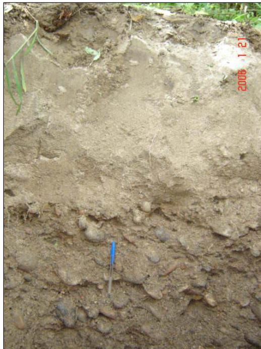
**Foto 22 - 5: Transición entre la matriz arenosa con guijarros y la matriz areno limosa. Se observa la capa limosa y vegetal al inicio de la excavación. Profundidad aproximada 0,40 m.**
