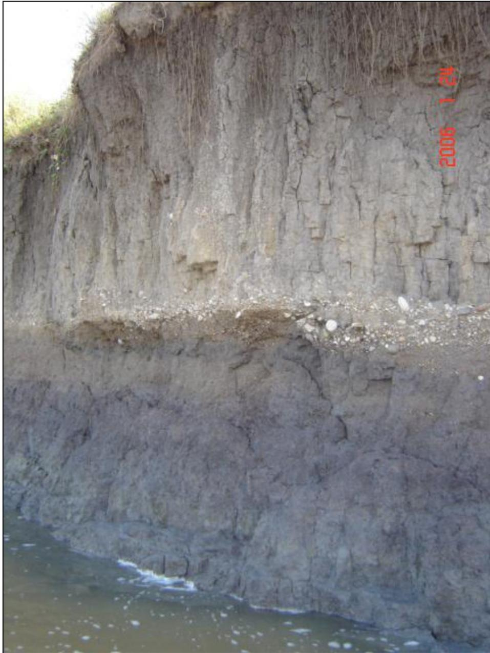
**Fotografía No 5.** En esta fotografía, se observa una capa de limo orgánico (0.7m), seguida de una capa de limo arenoso con presencia de algunas gravas (3m), en la parte media baja se observa una capa de gravas finas de unos 0.4m de espesor.
