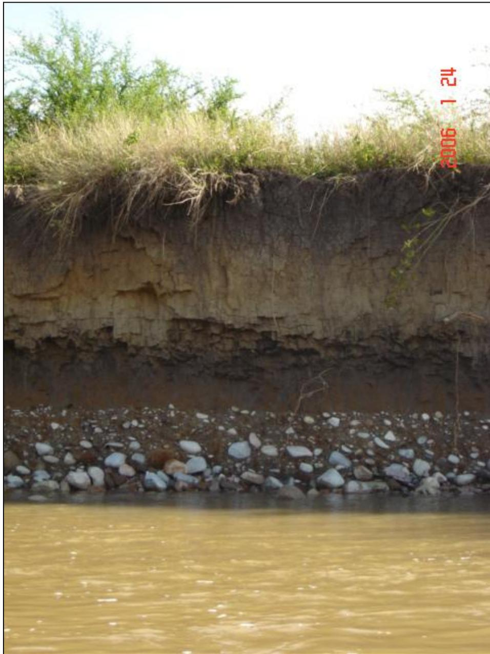
**Fotografía No 6. En esta fotografía, se observa una capa de limo orgánico (0.8m), seguida de una capa de limo arenoso limpio (3m), en la parte media baja se observa una capa de gravas finas y guijarros.**
