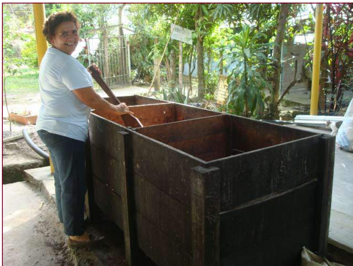
Cajón fermentador de tres compartimientos.
