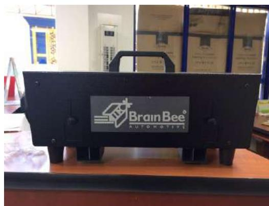
Equipo de medición de contaminantes por fuentes móviles, Banco de gases y Opacímetro
