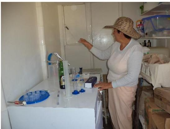
Probetas y peachímetro digital para laboratorio de vino.
