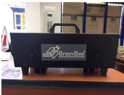
Foto: Equipo de medición de contaminantes por fuentes móviles, Banco de gases y Opacímetro
