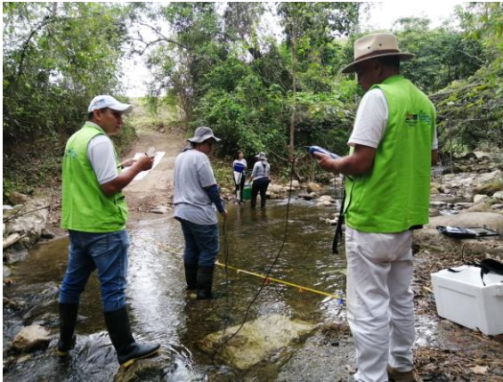
Mediciones de caudal en la quebrada Los Micos. Junio 2019
