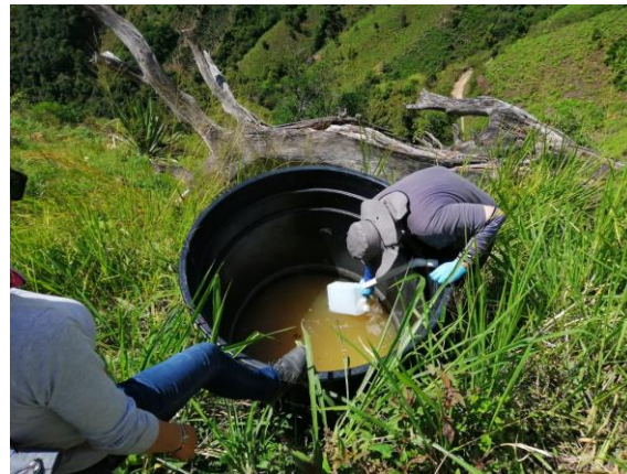
Toma de muestras para análisis de laboratorio en sistemas de tratamiento de aguas mieles.
