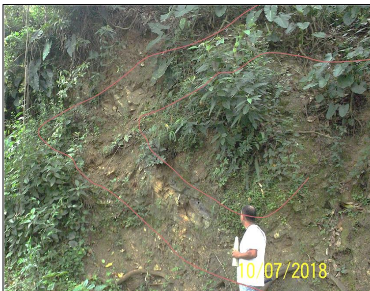
Ilustración 118. Vista del Neis de Guapotón en el cual se identifica el grado de fracturamiento de las rocas metamórficas.
