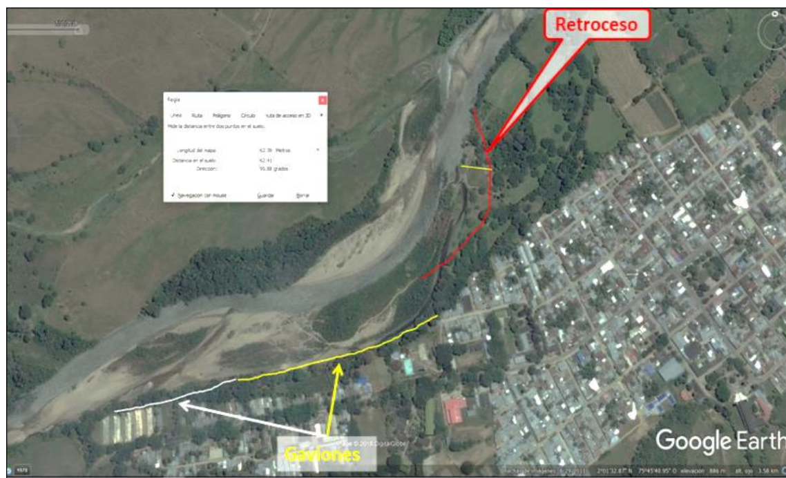
Ilustración 33. Imagen Google Earth, donde se compara la margen en el año 2011 con la margen 2018 (trazo rojo tomado con GPS) y en donde se observa un retroceso de la misma.
