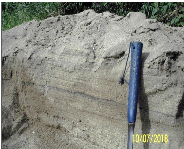
Ilustración 12. Coordenadas: E= 1146667, N= 715960 Depósito de lente de arenas con intercalaciones de láminas de material más fino y láminas de material conglomerático. Fuente: Geocing S.A.S.
