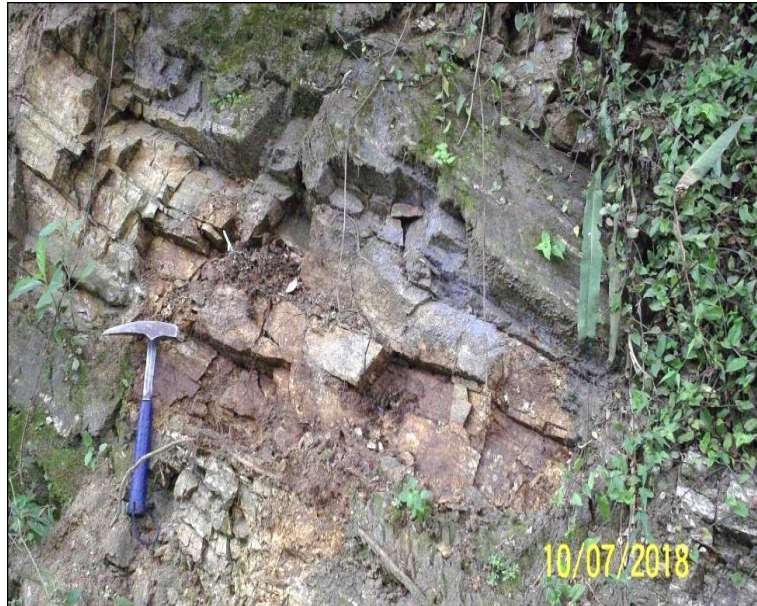
Ilustración 20. Coordenadas: E= 1147466, N= 715559. Roca meteorizada y fracturada del neis de Guapotón.
